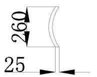
▲5.8.床横:采用≥21mm\*25mm\*29mm\*1.5mm 八角梯形冷轧钢管,在左右和下面各有一条直径 ≥3mm 凹型加强筋,增强抗扭曲性,越受力越紧 固。参考图如下:
