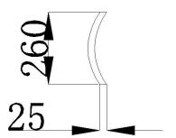
▲5.8.床横: 采用≥21mm\*25mm\*29mm\*1.5mm 八角梯形冷轧钢管,在左右和下面各有一条直径 ≥3mm 凹型加强筋,增强抗扭曲性,越受力越紧 固。参考图如下:
